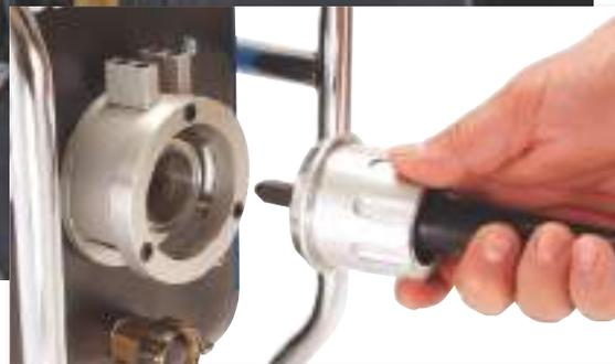
EJE DE CONEXIÓN RÁPIDA
