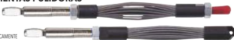
Las herramientas pulidoras de alambre de acero inoxidable se utilizan para la eliminación de depósitos de sarro ligeros o medianos y para el acabado de tubos con superficie rugosa por acción previa de otras herramientas de limpieza. Pueden utilizarse en tubos rectos, ferrosos y no ferrosos. Las herramientas pulidoras pueden utilizarse únicamente en sentido horario (directo) y no pueden utilizarse en tubos mejorados internamente. Son ajustables hasta un rango de 6,4 mm.
