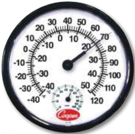
212-150 Termómetro de pared/Medidor de humedad de 12"
