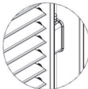
DETALLE VISTA INTERIOR (DAMPER L-DFA150) ACTUADOR
