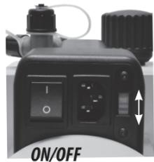
**TIP DE SERVICIO:** Utilice siempre la longitud más corta y el cable de extensión de calibre más grande posible al operar esta bomba de vacío.
