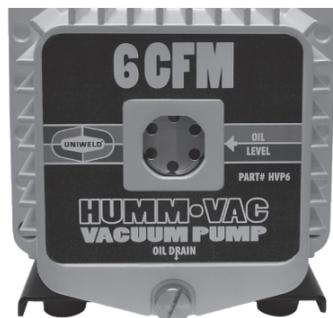
**⚠ ¡ADVERTENCIA!** Su bomba de vacío se ha enviado sin aceite en el depósito. Antes de iniciar la bomba, llénela con aceite. Retire el tapón de aceite y rellene con aceite de la bomba Uniweld Humm•Vac hasta que el nivel de aceite esté ligeramente por encima del centro de la mirilla. **NO** llene la bomba. Reemplace la tapa de llenado de aceite. La temperatura de funcionamiento de la bomba y el aceite debe ser de 30°F (-1.1°C) o superior.
