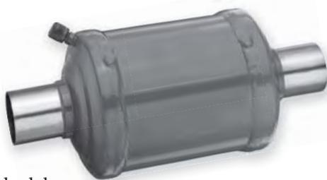
Los filtros de la línea de succión Parker Sporlan Catch-All® SF protegen a los compresores eliminando todas las partículas de los circuitos de refrigeración y de aire acondicionado. Estas partículas pueden ser depósitos de carbono o esquirlas metálicas resultado del desgaste del compresor o de la instalación de las tuberías.
