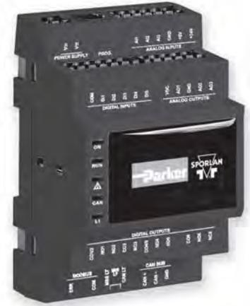
El driver para motor de pasos bipolar independiente **PSC** se ha diseñado para trabajar con las válvulas de expansión electrónicas **SER** y **SEH** de la familia de Parker Sporlan para controlar el recalentamiento. El PSC mejora el recalentamiento controlando la diferencia entre la temperatura real y la temperatura de saturación del refrigerante.
