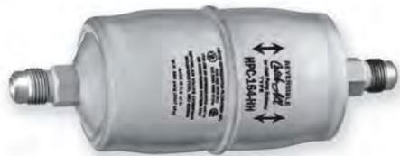
El filtros deshidratadores funciona en ambas direcciones del flujo, el refrigerante atraviesa los núcleos desde la cara externa hasta el espacio interno. Los filtros deshidratadores de doble flujo HPC Catch-All® no liberan la suciedad recogida en una dirección cuando la dirección del flujo se invierte.
